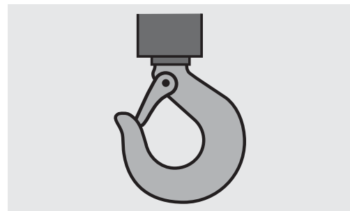
Fig. 5: gancio provvisto di sicurezza contro lo sganciamento.
