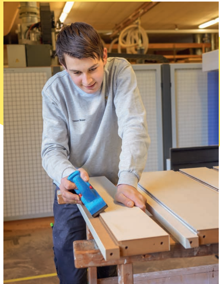
Timon Moser beim Kantenbrechen der Türrahmentraversen.
