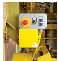
5 Tippsteuerung mit Not-Halt
